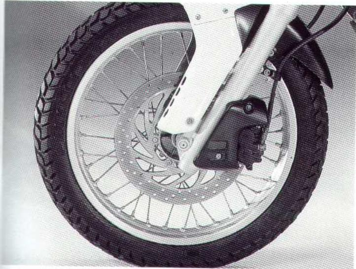
*Optima resistenza: l'efficace freno a doppio pistoncino con disco da 300 mm viene ulteriormente raffreddato attraverso la presa d'aria nella mascherina del parafango.*
