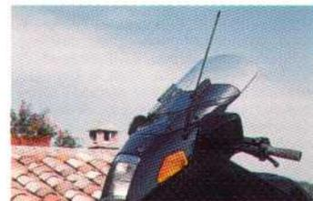
Parabrezza regolabile elettricamente: in dotazione di serie sulla BMW K 1100 LT; postmontaggio possibile sulla K 75 RT. Durante la marcia si può variare con continuità l'altezza e l'inclinazione del parabrezza.
