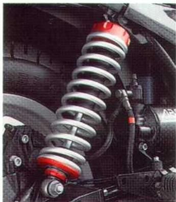
Il gruppo molla/ammortizzatore sportivo per la BMW K 75 RT ti consente di trovare in brevissimo tempo la taratura ideale della ruota posteriore. L'ammortizzatore ha 7 possibilità di regolazione in estensione, mentre nella fase di compressione si adegua automaticamente (sistema Duo-Control).
