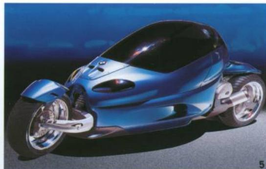
len von Automobil und Motorrad: Der Fahrer oder die Fahrerin dieses Zweirads sitzt angeschnallt in einer stabilen Karosserie mit Leichtmetallrahmen, der eine mit dem PKW in etwa vergleichbare Crash-Sicherheit aufweist.
